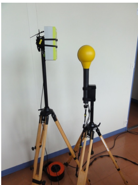
Figure 4 : compteur Linky et sonde de mesure installés sur des trépieds pour les tests
